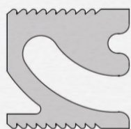
Zwischenprofil 4000 x 12,5 x 12 mm für Plattenstärken 16/19 mm
