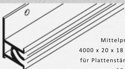
Mittelprofil 4000 x 22 x 19 mm für Plattenstärken 19 mm
