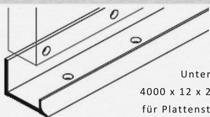
Mittelprofil 4000 x 20 x 18 mm für Plattenstärken 16 mm
